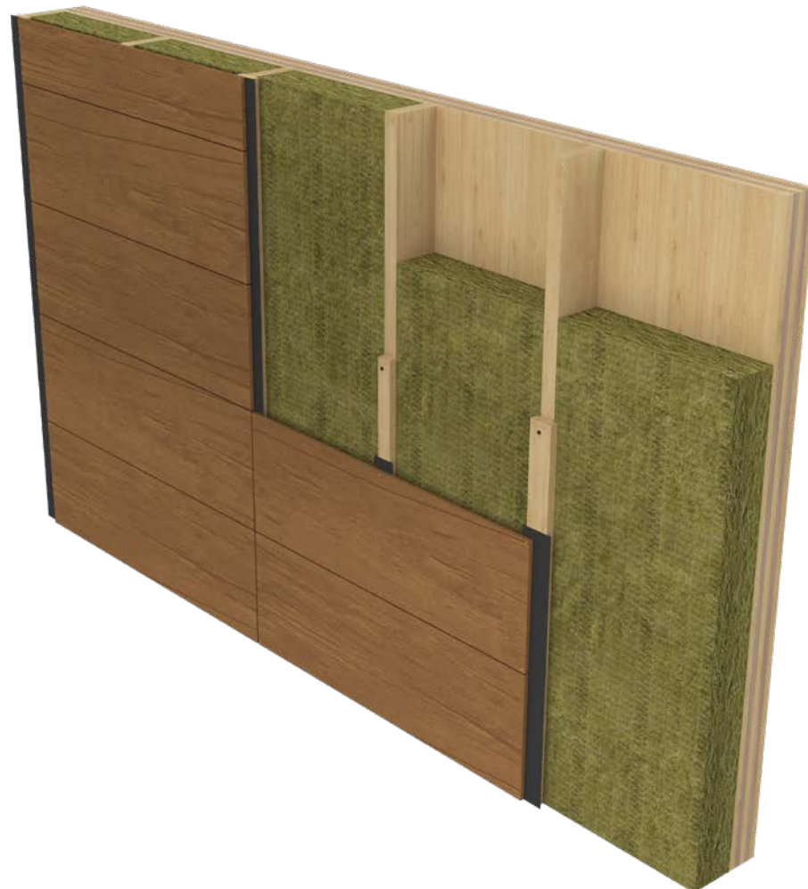
UNDERKONSTRUKTION AF TRÆ
